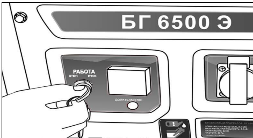
Рис. 17. Запуск двигателя электростартером
